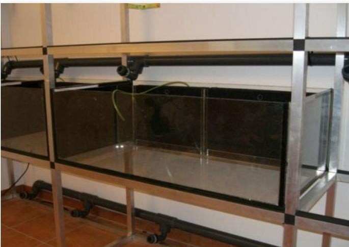
Die komplette Rückwand wird als Mattenfilter genutzt. Alle Becken haben eine Tiefe von 50 cm, 10 cm geht durch die Filtermatte und den Freiraum dahinter verloren. So hat jedes Becken seine eigene Filterung oder kann an den Zentralfilter angeschlossen werden.
