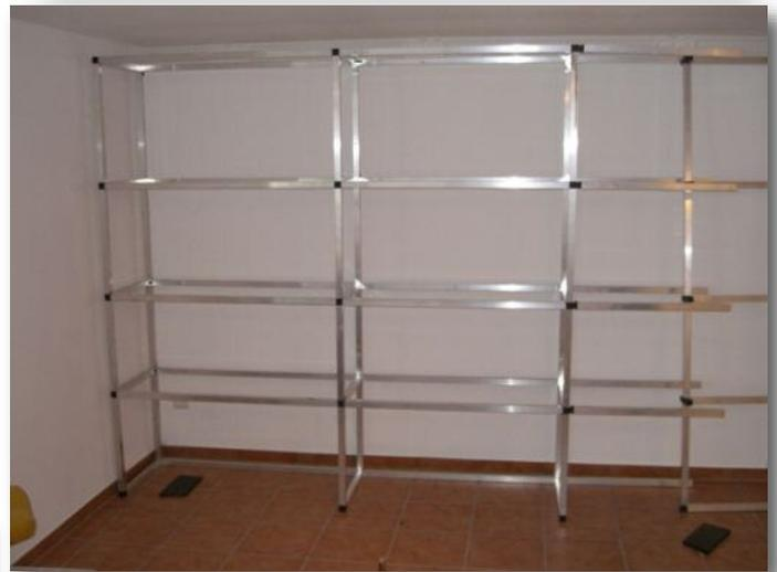
Das Grundgerüst besteht aus Alu-Vierkantprofilen 30 x 30 mm mit einer Wandstärke von 2 mm. Die Kunststoffverbinder haben einen V2A Stahlkern und eine Traglast von 400 kg pro Verbinder.
