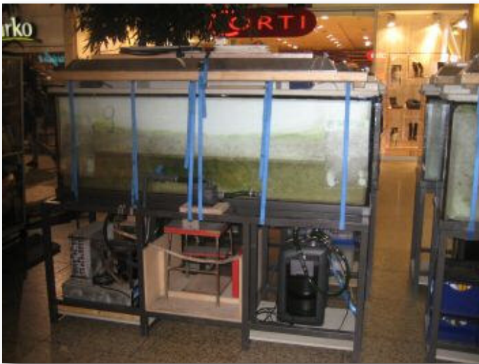
Herausforderung Transport: Kälteaggregat und Filter bleiben am Aquarium, die Minileiter ebenso. Foto: Marcel Weimer-Wiede
