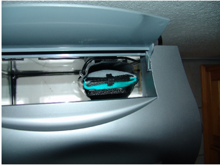
Zugang zum Filtereinsatz.
