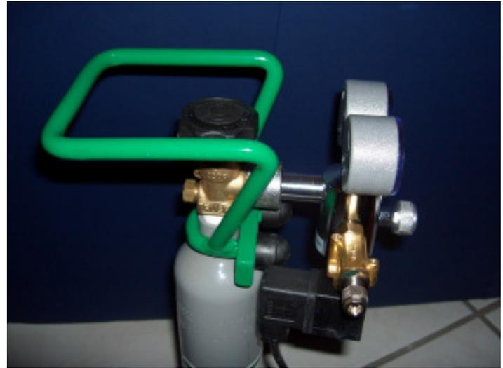
Wie im Bild erkennbar, ist der JBL Profi 3 das Magnetventil mit einem festen Anschlussstück am Druckminderer angebracht und braucht somit nicht mit Schlauch mit dem Druckminderer verbunden und gesondert befestigt werden.
