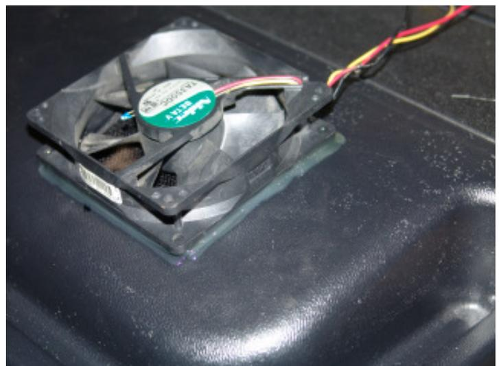
Der Ventilator wurde mit Heißkleber auf die Oberseite geklebt, nachdem der Kleber mit dem Mückennetz auf der Unterseite fest wurde.
