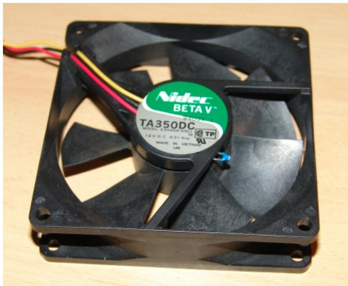
Mein Ventilator hat einen Temperatursfühler, der im Rechner diesen schneller laufen lässt, sobald eine gewisse Temperatur erreicht ist. Für meinen Betrieb reicht aber die „Leerlauf“-Drehzahl völlig aus.
