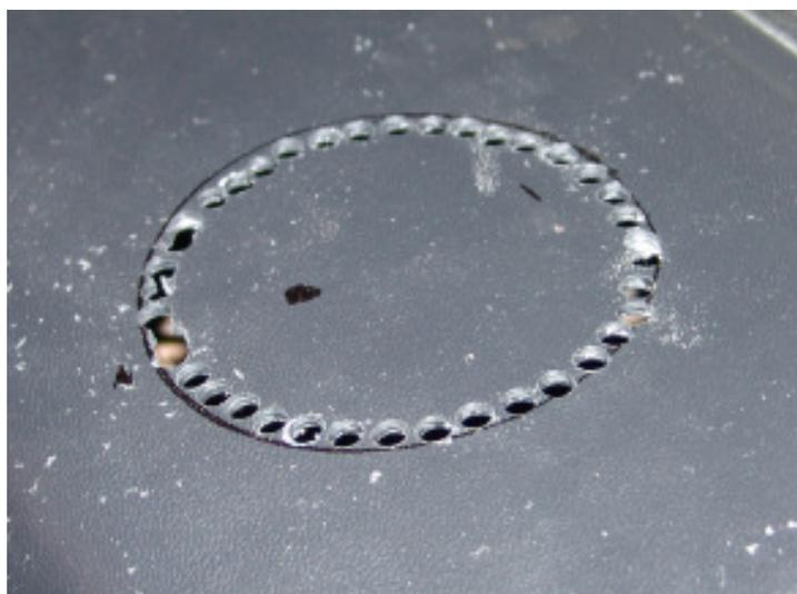
Hierbei habe ich die Löcher zuerst mit einer Bohrmaschine gebohrt, um ein Abbrechen der Abdeckung zu vermeiden. Das Loch habe ich später mit einem Teppichmesser aufgeschlitzt (siehe nächstes Bild).
