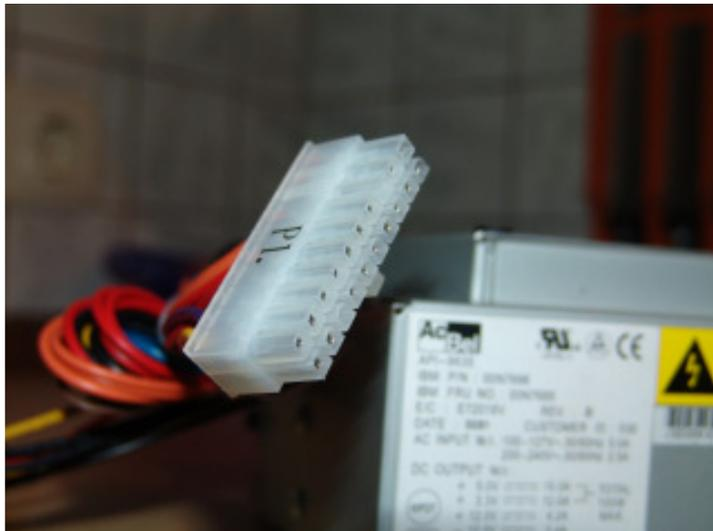
Zum Einschalten des Netzteils muss nur noch an diesem breiten Teil (oben) ein grünes Kabel mit irgendeinem schwarzen Kabel (meist daneben) zusammengeschlossen werden. An diesem Punkt kann man einen beliebigen Schalter anbringen und schon funktioniert das ganze.
