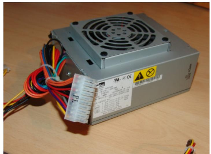
Hier reichte bereits ein altes 100W Netzteil aus, da der Ventilator kaum Strom verbraucht und das Netzteil nur soviel Strom abgibt/verbraucht, wie nun mal Verbraucher angeschlossen sind.
