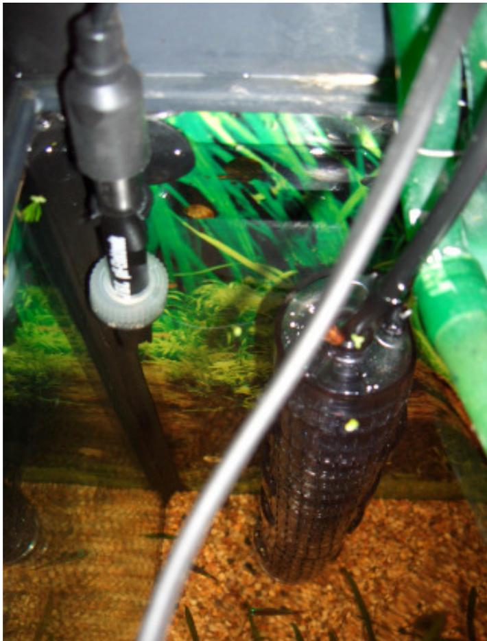
Links PH-Sonde; Rechts CO<sub>2</sub> Reaktor
