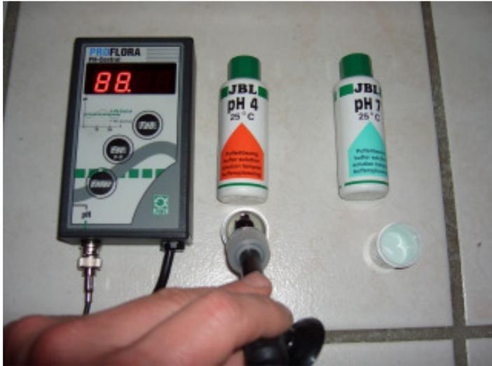
Nach Abschluss wechselt das Gerät selbstständig in den Messmodus.
