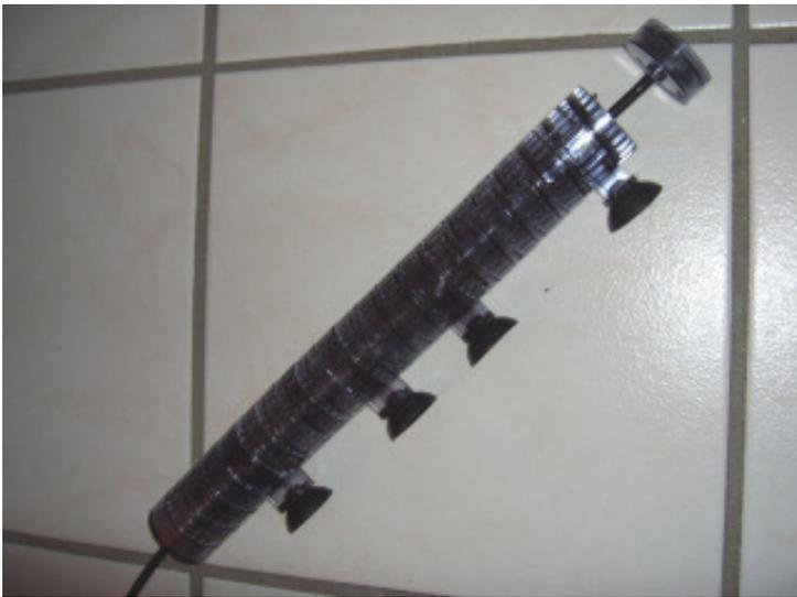
und steckt anschließend alle Teile so zusammen, dass die Windungen im inneren passgenau aneinander sitzen und die Saugnäpfe in eine Richtung ausgerichtet sind.
