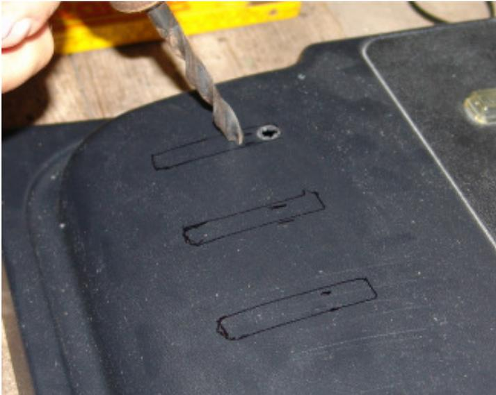
Die Lüftungslöcher wurden eingezeichnet und die Löcher nebeneinander gebohrt. Anschließend wurden die scharfen Kanten wieder geglättet:
