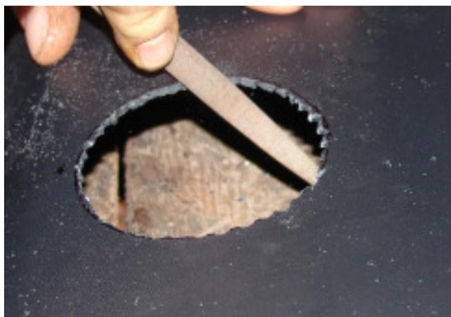
Fertig war das Loch, auf welches später der Ventilator geklebt wird. Nun galt es, auf der gegenüberliegenden Seite der Abdeckung, die Lufterlasslöcher/-schlitze zu bohren, wobei ich mich für eine Reihe von Löchern entschied, da ich durch Schlitze Unstabilität befürchtet habe.
