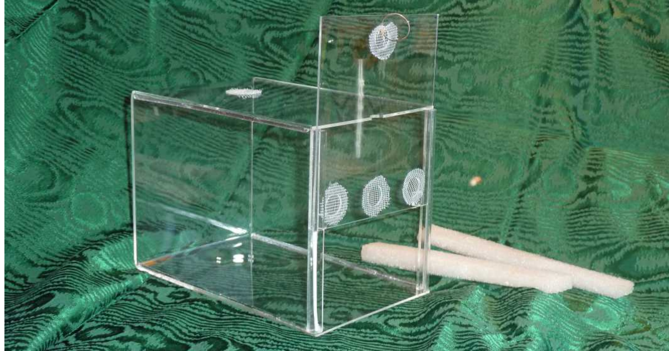
Die Fischfalle GENIUS; die vorgegebenen und zu großen Löcher wurden mit Netzmaterial versehen, um das Entkommen kleinerer Fische zu verhindern, beigelegt sind zudem Kunststoffstreifen, die seitlich oben angeklebt werden, um ein Schweben im Wasser zu ermöglichen.
