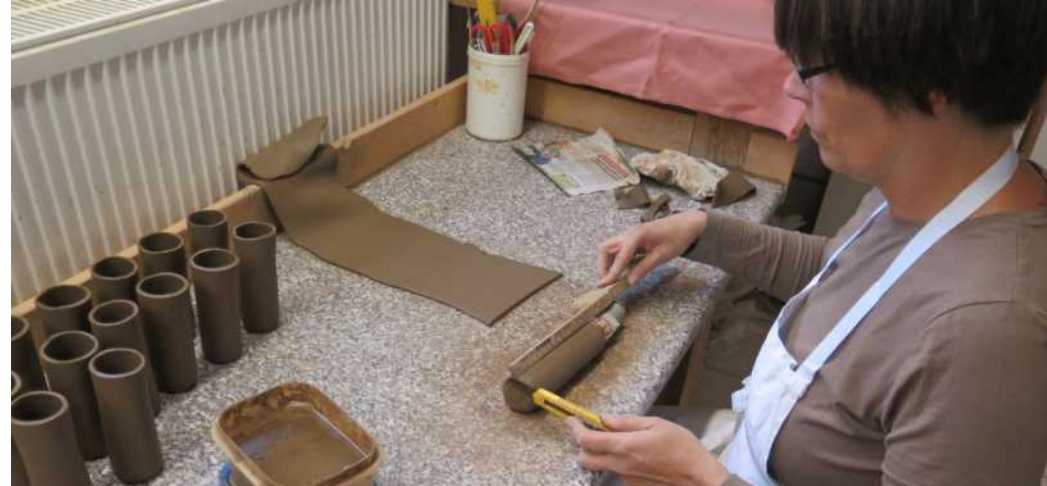
rechts: Mitarbeiterin Katrin Nagel beim Ablängen der Tonhöhlen
